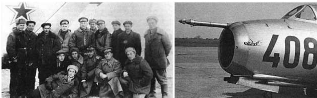
Na snímku vlevo: Účastníci zkušebních letů letounu MiG-15. Na snímku vpravo: Stíhací letoun MiG-15bis vybavený speciálním zařízením „Harpuna“ pro doplňování paliva za letu (pozdější modifikace).
