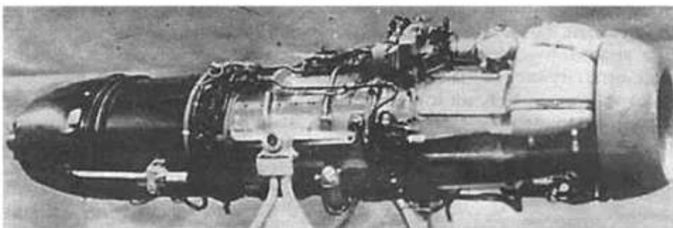
Motor RD-20, vyvinutý týmem konstrukční kanceláře vedeným S. D. Kolosovem (1904-1975), byl kopií německého BMW 003A, ale s významnými úpravami zaměřenými výhradně na zvýšení spolehlivosti a životnosti. Byl instalován na sovětský proudový stíhač MiG-9. Celkem bylo vyrobeno 2 911 motorů RD-20.
