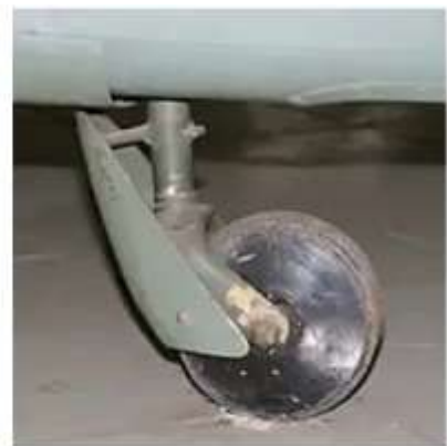
Fotografie vpravo jasně ukazuje ocelový potah podél trupu, chránící jej před horkými výfukovými plyny, a celooceľové ostruhové kolo.
