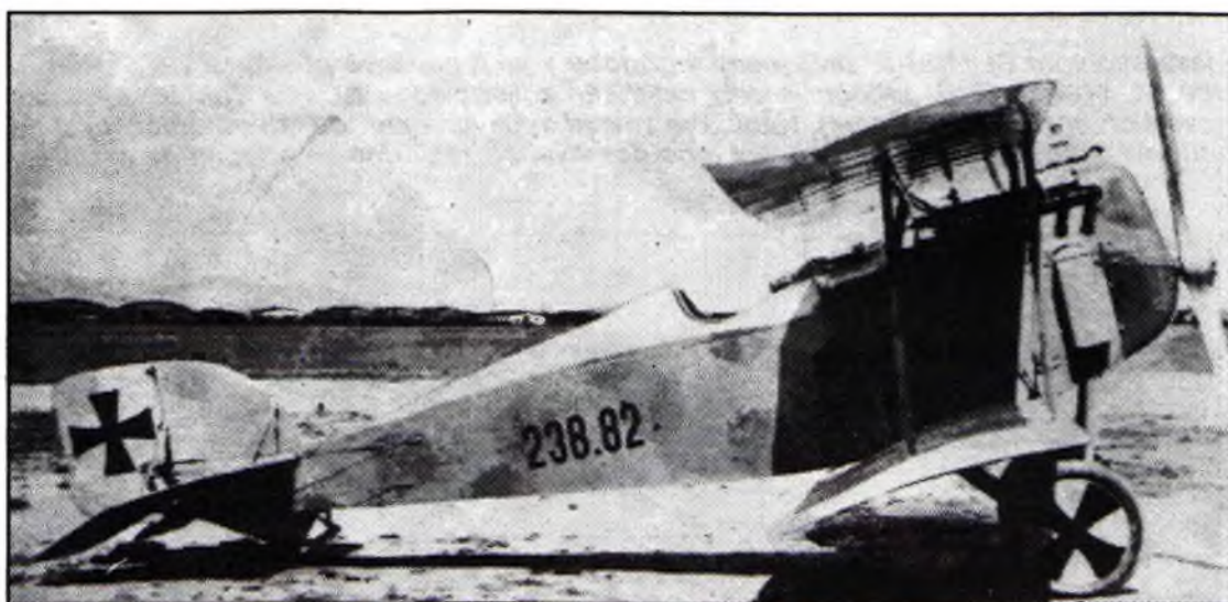
Jeden z Aviatiků série 238 vybavený bočními chladiči. Zde stroj 82.
