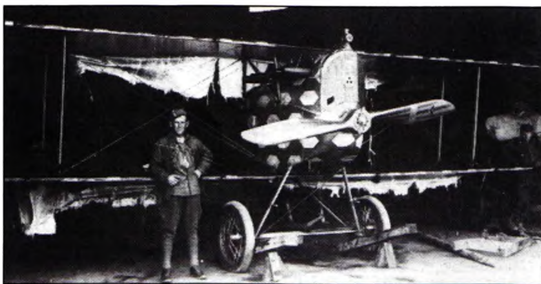
Výsledek souboje nad frontou. Pilot C. Seiboth z Jablonce n. Nisou před svým Lohnerem série 115 se strhaným potahem křidel. (Archiv NTM v Praze.)
